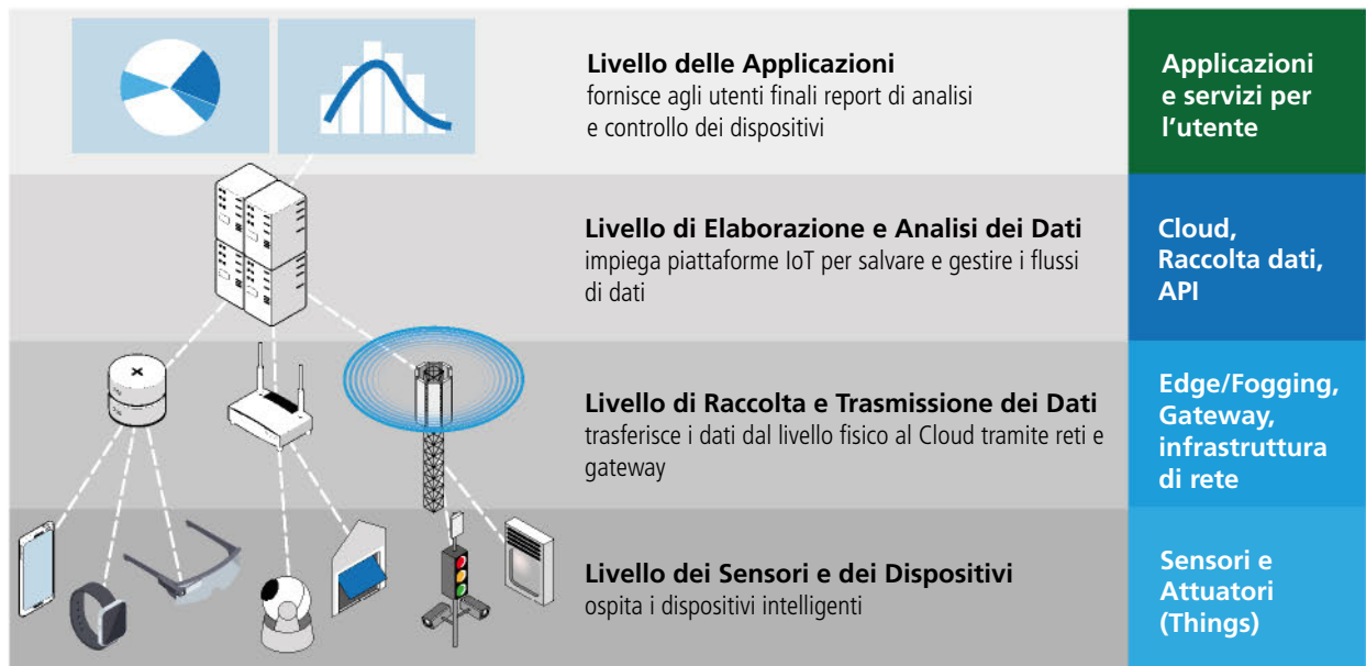
↓ Fig. 3 Architettura multistrato dei collegamenti IoT. I dati sono in transito fino al raggiungimento del livello del cloud, quando i dati, finalmente a riposo, sono disponibili per l'analisi e l'uso da parte delle applicazioni.
