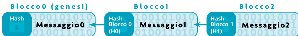
↑ Fig. 8 In ogni blocco della catena è salvato il codice hash del blocco precedente. Nel blocco genesis è contenuto il Messaggio0 senza l'hash. Il Blocco1 contiene, insieme al Messaggio1, l'hash di Messaggio0 (H0). Il Blocco2 contiene anche il codice che autentica Messaggio1 (H1) e così via.
