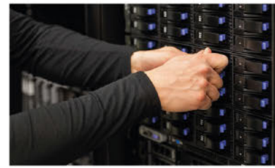
↑ Fig. 5 La sostituzione di un disco in un array RAID in un SAN.
