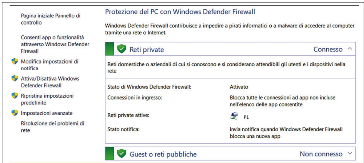
↑ Fig. 4 Windows Defender Firewall filtra il traffico di rete in entrata e in uscita dal dispositivo (in questo caso un PC) bloccando pacchetti indesiderati.
